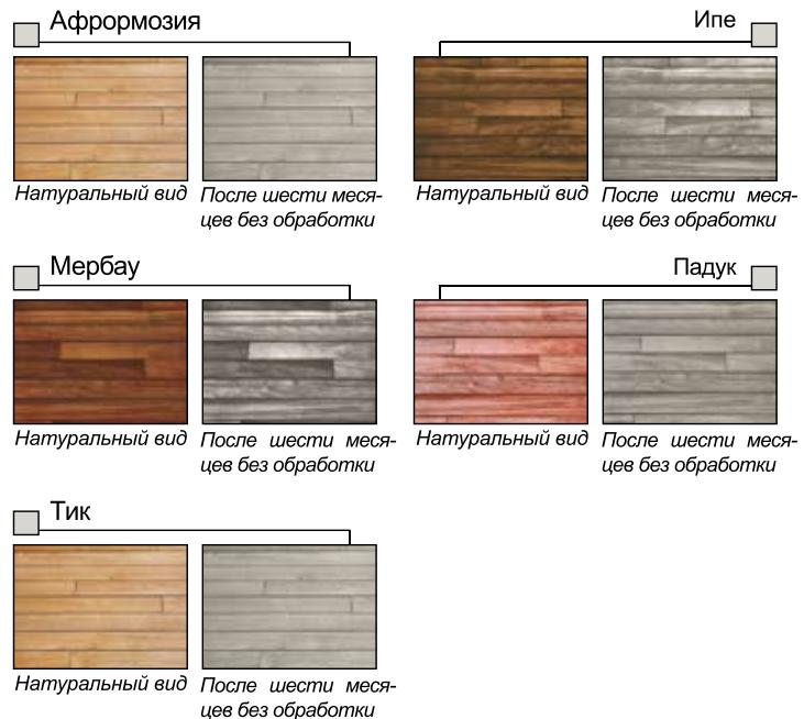
Террасная доска предлагается с единым размером профиля 20 x 100 x 2000 (основная длина), 20 x 96 x 2000 для Тика. Доски крепятся при помощи скрытых элементов крепления системы Softline®.
